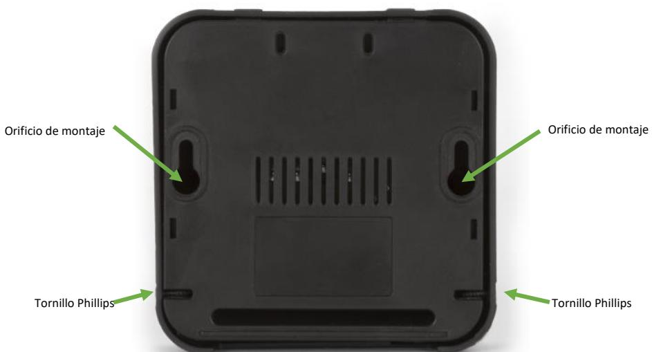
Gracias a los 2 orificios de montaje de la parte trasera de la carcasa es fácil fijar el receptor a la pared o el techo. Los agujeros tienen un diámetro de 6,3 mm y el centro de cada agujero está a una distancia de 62,9 mm uno de otro. Para abrir la carcasa, afloje los dos tornillos Phillips.
