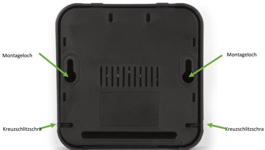
Dank der 2 Montagelöcher (Rückseite) lässt sich der Empfänger einfach an der Wand oder Decke befestigen. Die Montagelöcher haben ein Durchmesser von 6,3 mm und die Mittelpunkte der Löcher befinden sich in einem Abstand von 62,9 mm voneinander. Lösen Sie die zwei Kreuzschlitzschrauben, um das Gehäuse zu öffnen.
