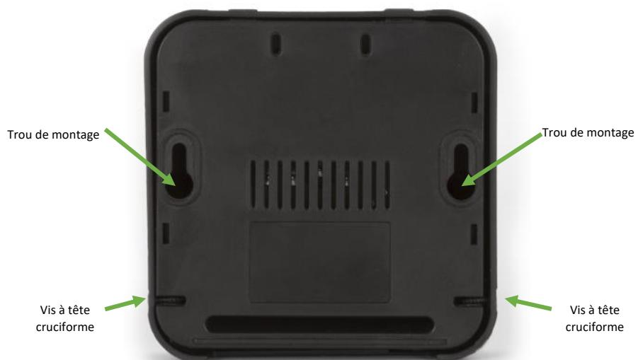
Le récepteur peut être installé facilement contre une paroi ou au plafond à l'aide des 2 trous de montage. Ces trous de montage ont un diamètre de 6,3 mm, le centre de chaque trou étant à une distance de 62,9 mm l'un de l'autre. Desserrer les 2 vis pour ouvrir le boîtier.
