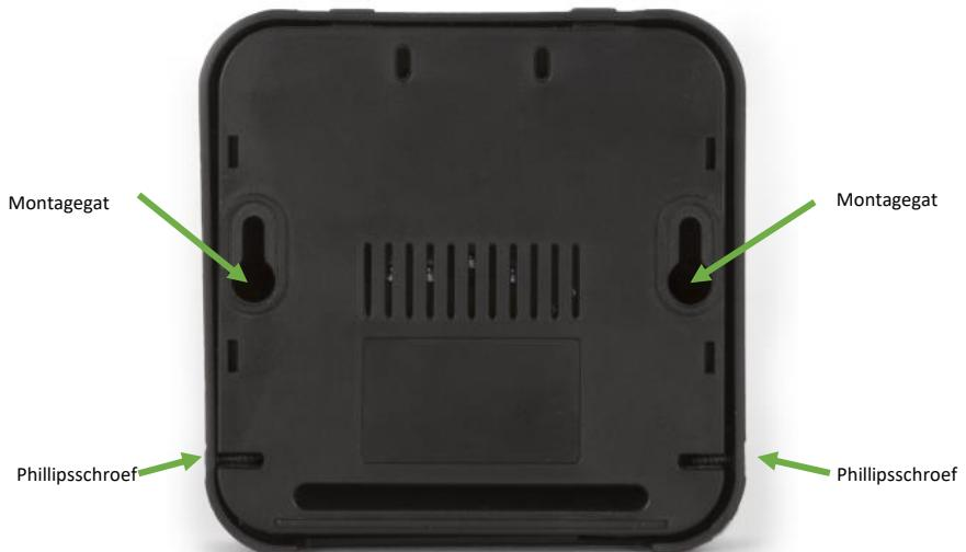
De ontvanger kan gemakkelijk gemonteerd worden tegen een muur of plafond met de 2 montage gaten in de achterkant van de behuizing. De montage gaten hebben een diameter van 6.3 mm en de middelpunten van de gaten liggen 62.9 mm van elkaar. Schroef de 2 Phillips schroeven los aan beide kanten van de behuizing om deze te openen.
