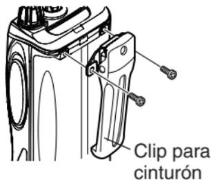
Si es necesario, fije el clip para cinturón utilizando los dos tornillos M3 x 8 mm suministrados.
