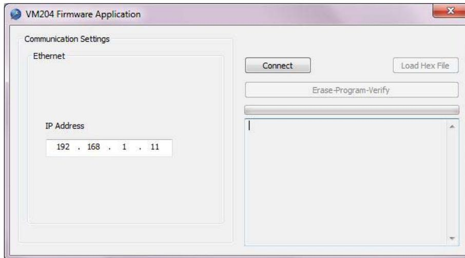
5. ¡Ojala recuerde la dirección IP! Introdúzcalo junto a 'IP Address' y pulse <Connect>. Normalmente, se visualizará 'device connected'.
