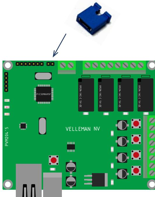
4. Desconecte el cable USB y vuelva a conectarlo para desactivar la VM204 y volver a conectarla.
