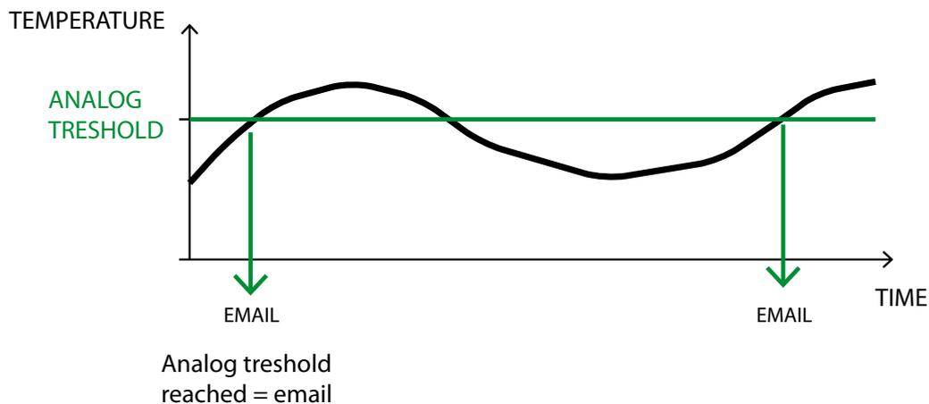
Introduzca el valor umbral en la casilla junto a 'Alarm value' después de haber seleccionado esta acción en la lista (véase fig.). Seleccione el valor de alarma entre 1 y 1024. Calcule este valor multiplicando el valor de tensión por 155. Por ejemplo: si su valor de tensión es 3.3 V, proceda de la forma siguiente:  $3.3 \text{ V} * 155 = 511.5 \Rightarrow 512$ . Números de punto flotante no valen. Por ello, redondee el valor hacia arriba o hacia abajo. La tensión máxima es de 6.6 V (=1024).
