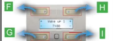
**E** Change the status of the alarm into ON or OFF - De alarmstatus aanpassen naar ON of OFF - Régler l'état d'alarme sur ON ou OFF - den Alarmstatus ändern: ON oder OFF - modificar el estado de la alarma: ON u OFF
