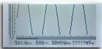
Gire RV1 un poco más hacia la derecha. Ahora, la señal desaparece de la pantalla y la lectura Vrms visualiza ?????mV porque el osciloscopio ya no puede calcular el valor Vrms correcto.
