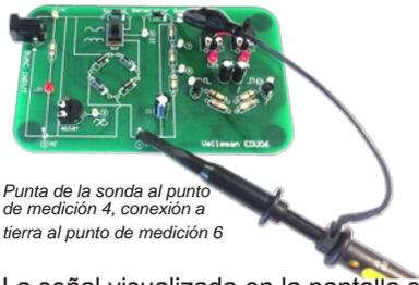
Punta de la sonda al punto de medición 4, conexión a tierra al punto de medición 6
